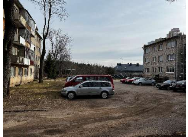
Esama kiemo dangų, želdinių padėtis tarp Vytauto skg. 10 ir Vytauto skg. 12. Matoma dalinai išlikusi kiemo buvusi struktūra. Kietos dangos nusidevėjusios. Nėra atkirti pėsčiųjų takai nuo važiuojamosios dalies. Esami medžiai auga greta pastato. Lietaus vanduo nuleidžiamas ant žaliųjų, kietųjų dangų.
